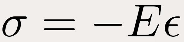
Steel: E=10<sup>11</sup> N/m<sup>2</sup> Rubber: E=10<sup>7</sup>~10<sup>8</sup> N/m<sup>2</sup>
